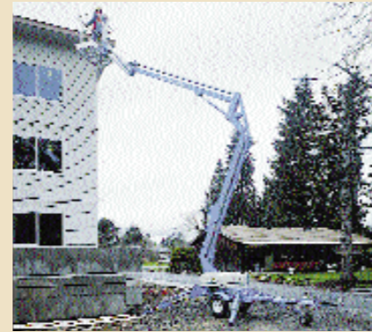
130 Grad Arbeitsbereich des Korbauslegers
