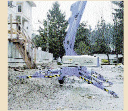
Option: Hydraulische Abstützungen mit automatischer Nivellierung
