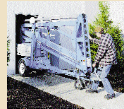
Optionale einfahrbare Achsen Die Verfügbarkeit von Optionen kann durch regionale Beförderungsgesetze eingeschränkt sein.
